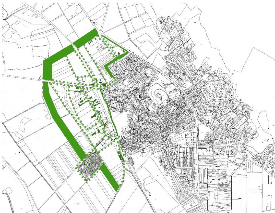
36. ábra Tervezett ipari zöldöv elhelyezkedése (saját ábra)
